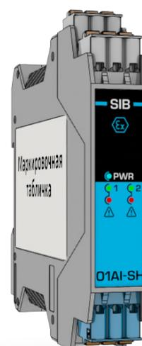
Изолирующий повторитель аналогового сигнала 0(4)...20 мА из взрывоопасной зоны, «прозрачный» для двустороннего обмена по протоколу HART. Может быть использован для питания датчика. Трехсторонняя изоляция вход/выход/питание. Индикация обрыва и короткого замыкания линии связи с датчиком. SIB-01AI-SH обеспечивает дополнительно функцию разветвителя входного сигнала на два выходных.
